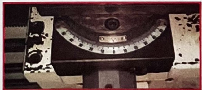
รูปที่ 10.10 ขีดองศาสำหรับตั้งกลึงมุมเรียว
