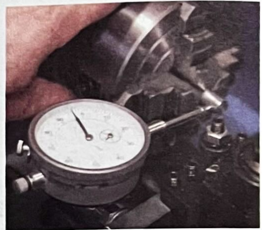
รูปที่ 10.39 กรณีจับชิ้นงานด้วยหัวจับสี่จับพื้นอิสระ ต้องใช้ช้อนช่างหรือนาฬิกาวัดตรวจสอบให้ได้ศูนย์ก่อน
