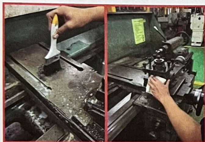
รูปที่ 10.55 ทำความสะอาดโดยใช้แปรงขัดเศษโลหะ และใช้ผ้าทำความสะอาด
