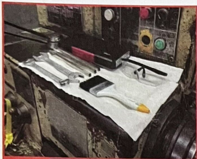
รูปที่ 10.53 เครื่องมือมีผ้า หรือยางรองรับ แยกเครื่องมือวัดต่างหาก
