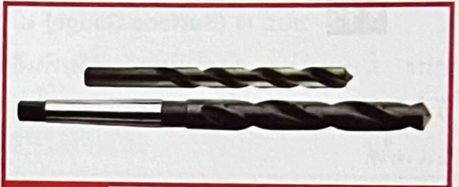
รูปที่ 10.28 ดอกสว่านก้านตรงและดอกสว่านก้านเรียว
