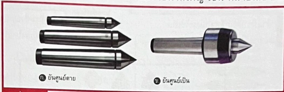
รูปที่ 10.18 ยันศูนย์ตาย และยันศูนย์เป็น
